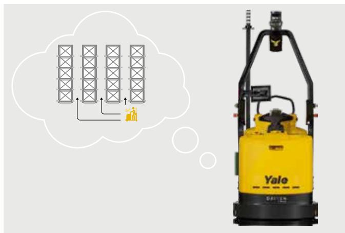
Etapa 3 – El mapa de referencia se integra en el ordenador del robot.
